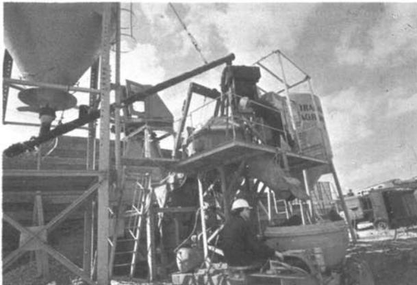
culos. Dicha planta, semiautomática, posee una mezcladora activadora de eje vertical, que fabrica un hormigón muy homogéneo, de gran plasticidad y calidad, debido al flujo producido por sus palas especiales.
