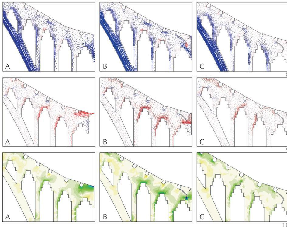
Es importante indicar que a medida que se desarrolla la fisuración se intensifican las zonas traccionadas existentes en el modelo "A", sin embargo, no llegan a superar a las tracciones que se producen en el sentido opuesto.
