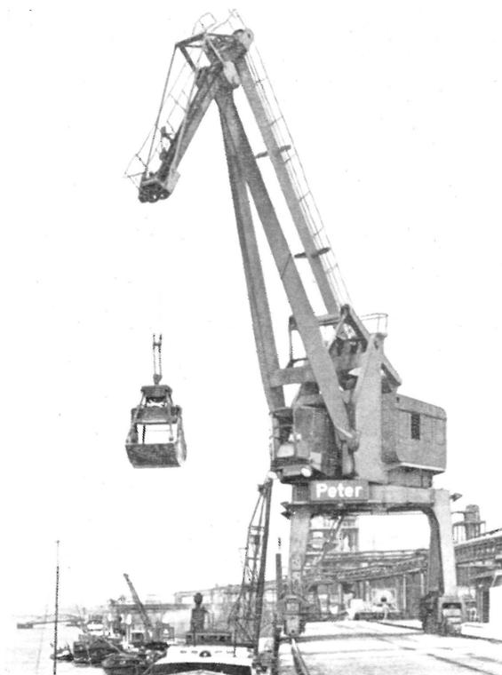
El bastidor automotriz forma un pórtico o torre simétrico, o asimétrico, con objeto de no estorbar el tráfico al nivel del suelo.
