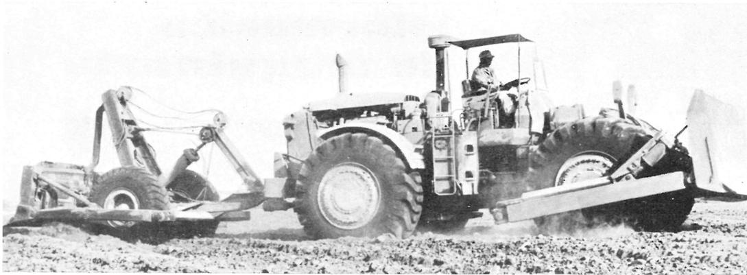
En un suelo blando un tractor de ruedas arrastra un «arado» de 8 t con el fin de someter al motor a una sobrecarga sostenida para una prueba de lubricación de engranajes.
