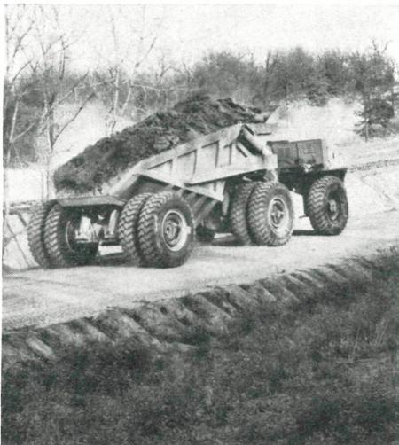
Se están efectuando pruebas del prototipo mayor del mundo que indica la figura 9. Tiene una capacidad de 160 t y el peso bruto total es del orden de 250.000 kilogramos.
