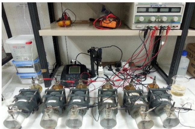
Figura 2. Montaje de ensayo multirégimen según norma UNE 83987.
