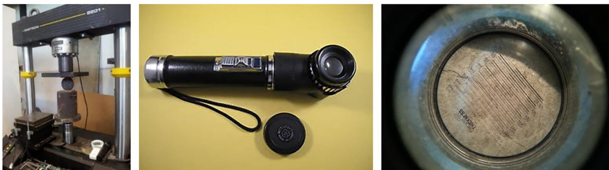
Figura 1. Sistema de fisuración de rodajas de hormigón empleado. Fisurómetro Mitutoyo usado para medida de ancho de fisura.
