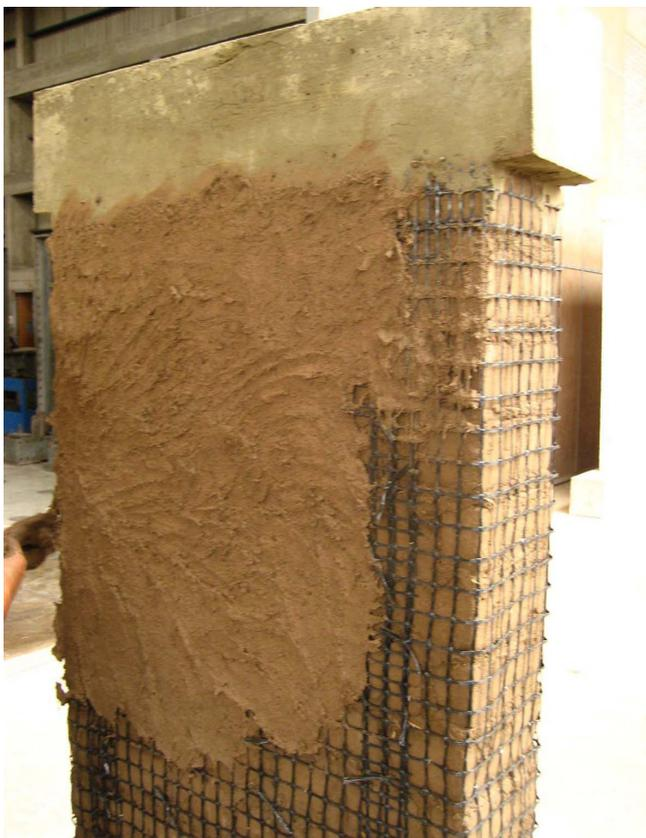
Figura 1. Muro de adobe reforzado con geomalla que ilustra las distintas capas correspondiente a cada fase de construcción (29).
