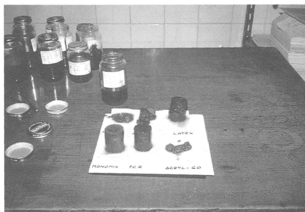
Ensayos de ácidos, efecto del ácido cítrico y de los aceites vegetales.
