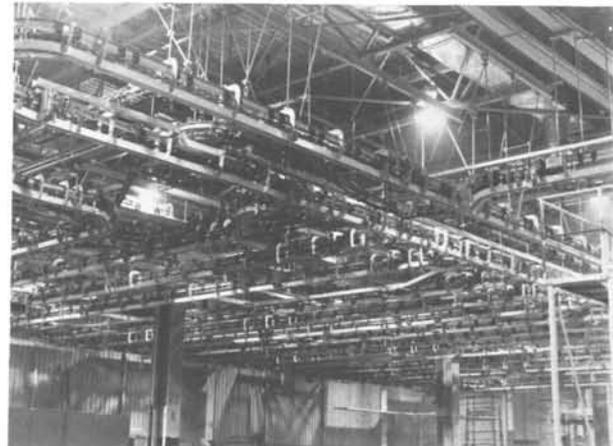
Recorrido de la instalación transportadora, por la zona de apilamiento, para la infraestructura de una carrocería.
