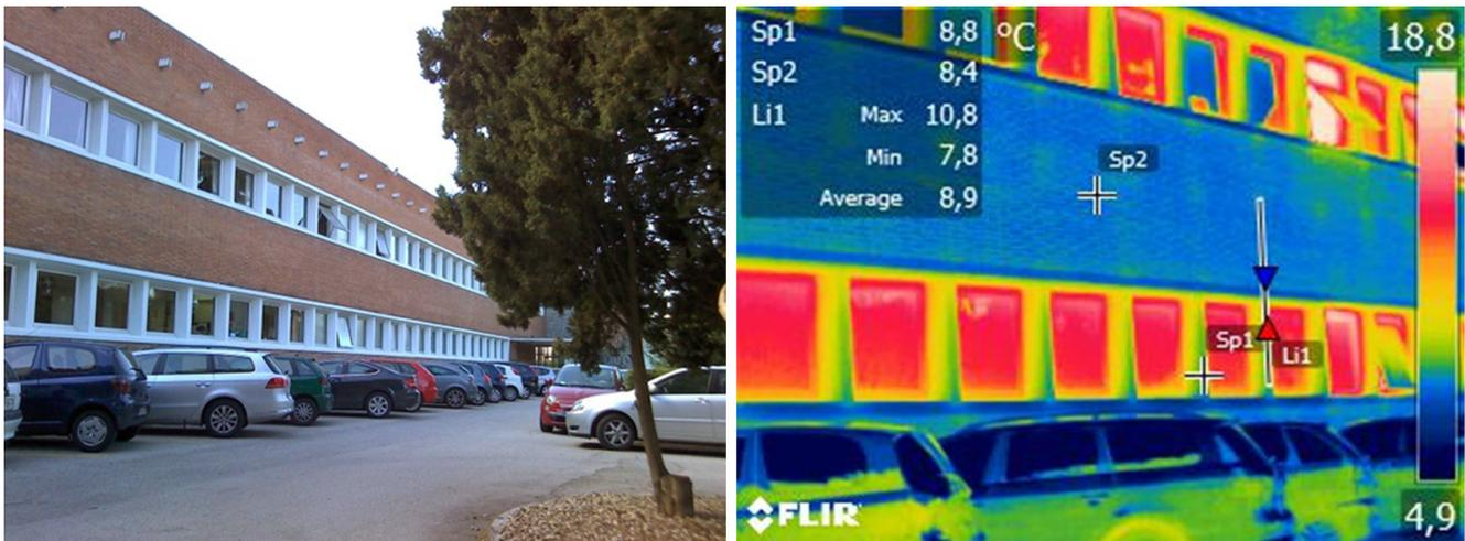
Figura 6. Vista de las ventanas de la fachada norte del IETcc. Termografía de la fachada norte.
