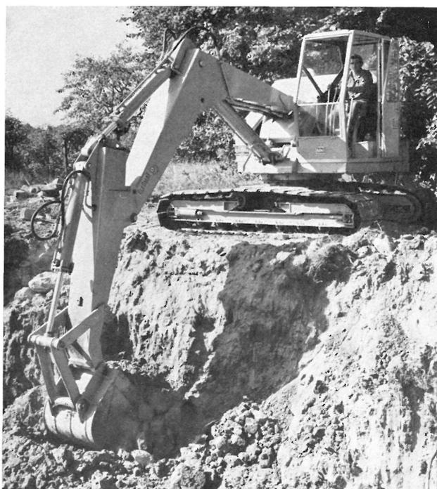
Es el dispositivo delantero acoplable a la estructura de las palas excavadoras para ejecutar trabajos de nivelación, excavación de zanjas y trincheras, etc.
