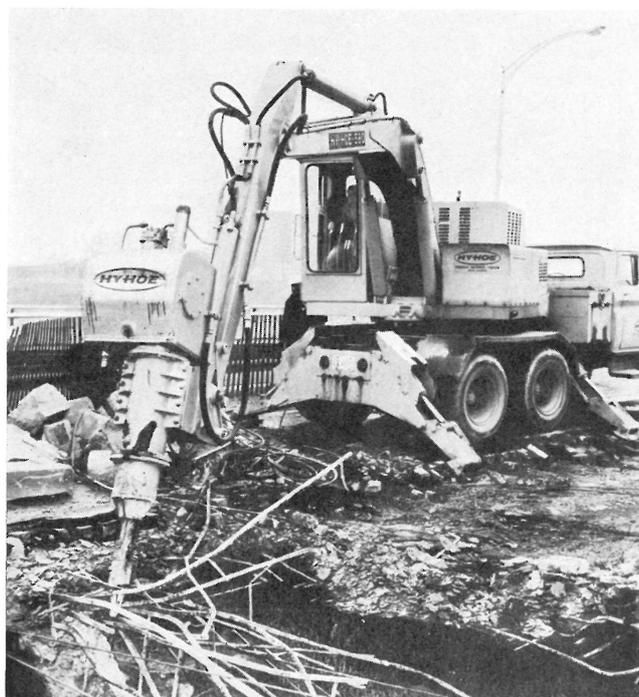
Elemento auxiliar para ser acoplado a algunas máquinas hidráulicas y que permite disponer de una fuerza de percusión, a 100 ciclos/min, del orden de 15.000 kg/cm<sup>2</sup> en 60 segundos y en cualquier dirección, siendo posible también efectuar estos trabajos bajo el agua.
