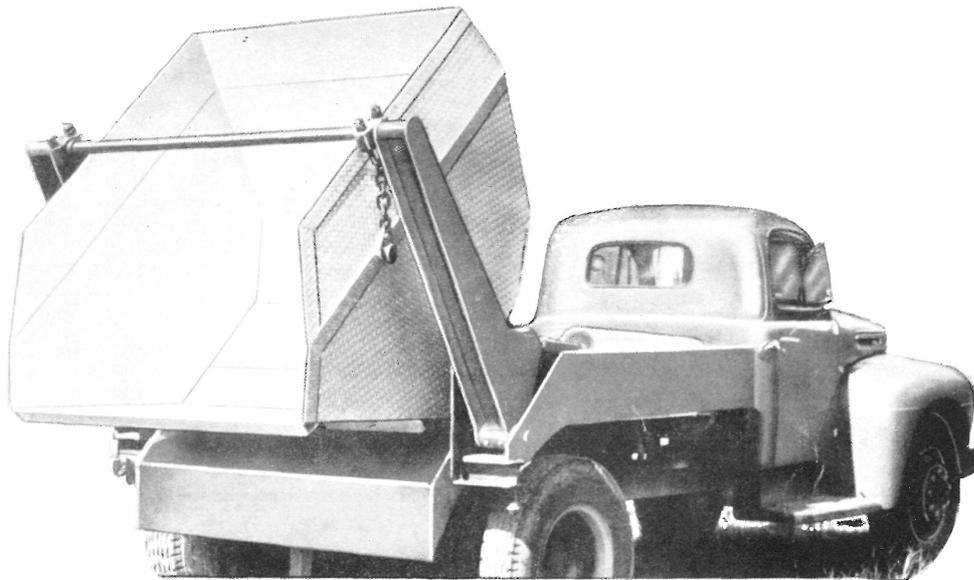
Permiten depositar las cajas en los puntos de carga, recogiendo una vez llenadas en una operación que solamente requiere de 15 a 20 segundos de duración.
