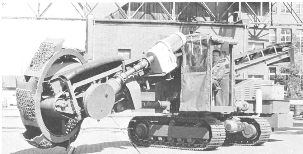
Estas máquinas son el punto inicial de las cadenas de transporte. La rueda recoge materiales sueltos de distintas clases, para lo cual pueden serle adaptados diversos tipos de cangilones.
