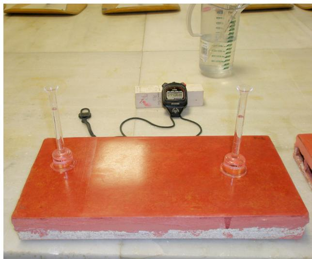
Figura 6. Ensayo de permeabilidad superficial.
