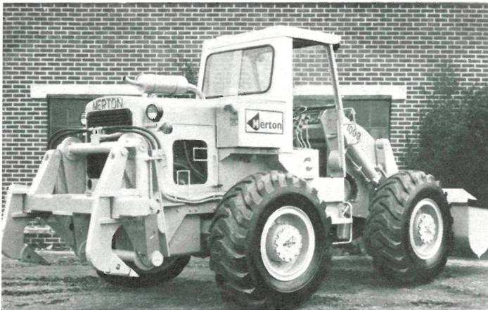
Ha sido proyectado un escarificador especial de doble púa, que puede ser acoplado a una pala cargadora para deshacer aquellas zonas apelmazadas que dificulten el trabajo.
