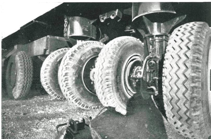
Esta grúa no está proyectada para ser empleada simultáneamente en la elevación y el traslado de cargas, por lo que va dotada de una única fuente de potencia; la transmisión se realiza por un sistema mecánico, lo que permite la instantaneidad de respuesta. Los sistemas de frenado, mando de la caja de cambios, y cabrestantes se efectúan por un circuito neumático, y la instalación eléctrica y los dispositivos de seguridad son similares a los de otros tipos de grúa semejantes.
