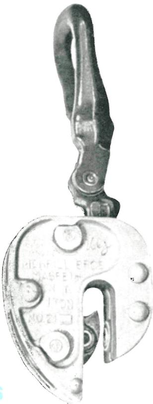
Fabricadas en capacidades desde 0,5 a 7 t, cada una de ellas se prueba antes de su entrega para cargas tres veces superiores. Sus características las capacitan para poder asir de una forma fácil y segura, chapas, perfiles, vigas, bordes de bidones, etc., con gran facilidad de manejo y sencillez.
