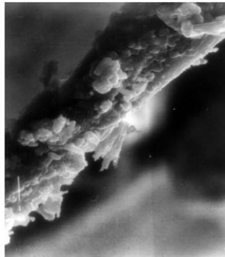
Sin embargo, la adición de fibras de polipropileno como elemento de refuerzo de la escayola produce disminuciones en general de los valores de resistencia mecánica ante tensiones de compresión.
