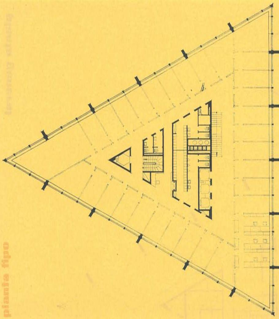
Las oficinas, dotadas de instalación de aire climatizado, están situadas a lo largo de todo el perímetro del edificio. Se separan unas de otras mediante tabiques móviles, colocados según una trama correspondiente con el módulo de composición, pudiendo así formarse células individuales, o células más complejas. Los despachos de la dirección, en el quinto piso, gozan de orientación sur y tienen los tabiques de separación fijos.
