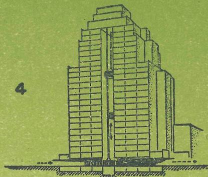
**4** Una batería de montacoches permite llegar a una mayor efectividad que la solución anterior, eliminando el puente-grúa, a base de multiplicar el número de aparatos de elevación.
