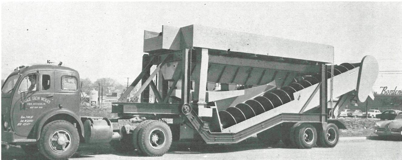
EE. UU.—La casa Eagle Iron Works, de Des Moines, en Iowa, fabrica esta dosificadora móvil para áridos, que puede operar por vía seca o húmeda.
