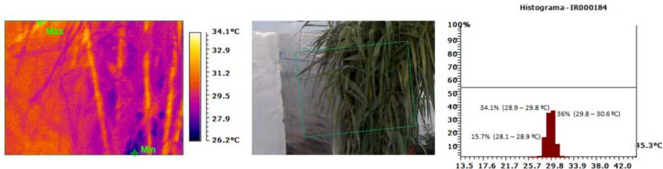
Figura 7. Termografía de la pared con y sin barrera verde de Arundo donax .
