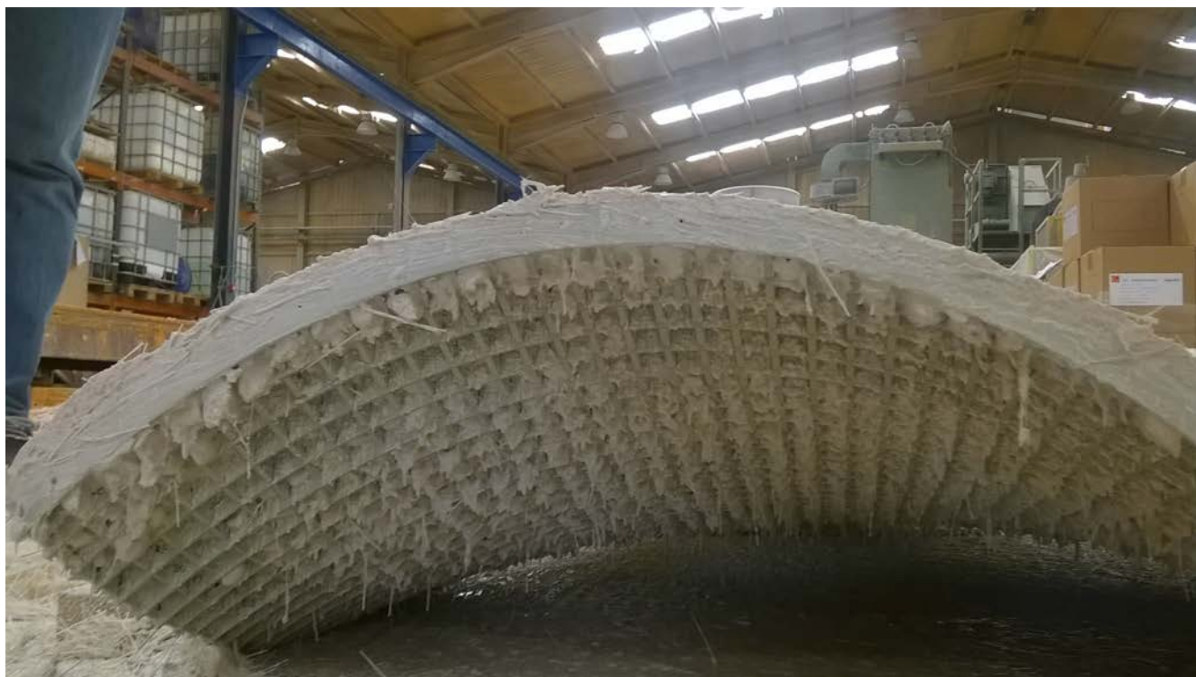
Figura 8. Malla con capa de GRC, que demuestra que la mezcla no traspasa por completo las celdas.
