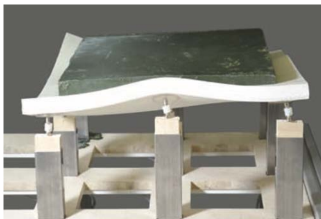
Figura 6. Panel de hormigón sobre molde de cera, la cual a su vez está sobre barras controlables.
