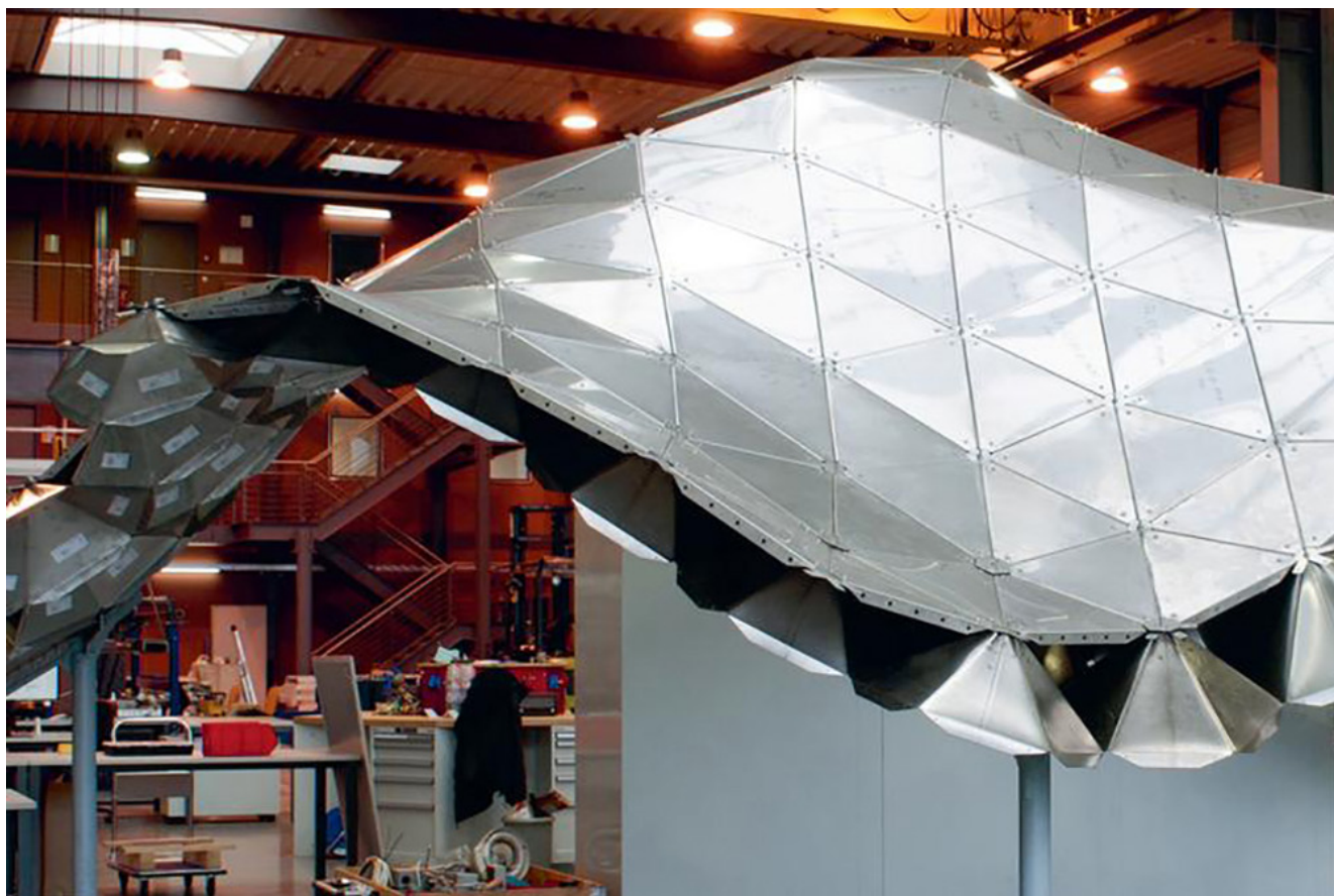
Figura 4. Proceso Incremental sheet forming, pieza diseñada por Dabid Bailey del Institute of Metal Forming, RWTH, Universidad Aachen, Alemania.
