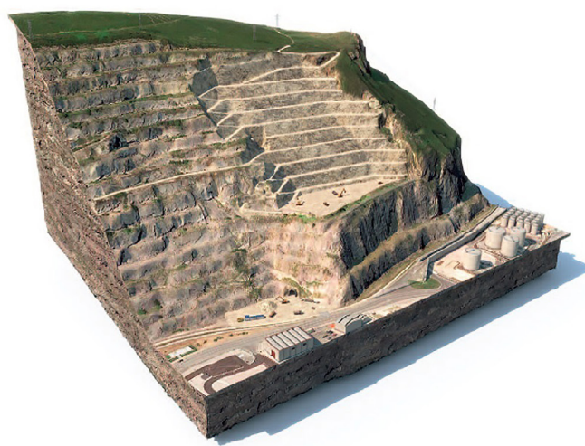
Figura 2. Geometría de talud inestable, antes de los trabajos (izda.) y geometría de talud estable, después de los trabajos (dcha.)
