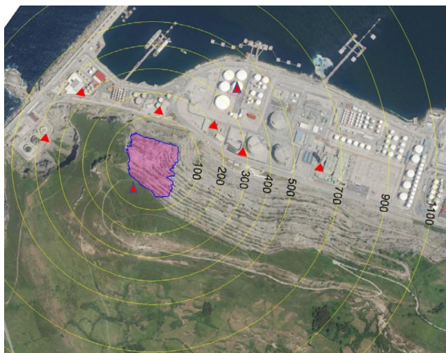
Figura 20. Localización en planta de los equipos de registro de vibraciones y ondas de presión en modo continuo
