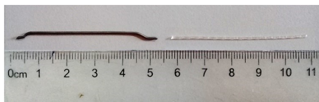
Figura 1. Fibra de acero (FA) con extremos conformados (izquierda); Fibra rizada de polipropileno (FPP) (derecha).
