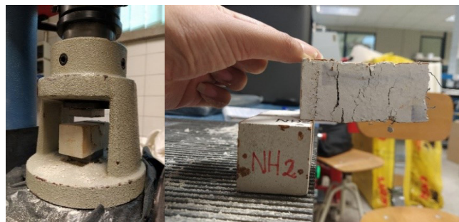
Figura 8. Probeta sometida a ensayo a compresión (a), probeta NH2 posterior a ensayo de resistencia a compresión.
