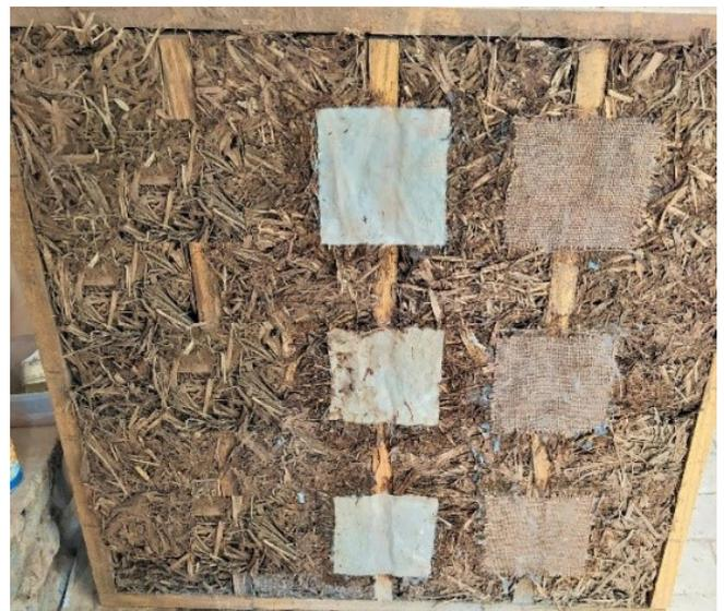
Figura 4. Capas de agarre en paneles para cizallamiento.
