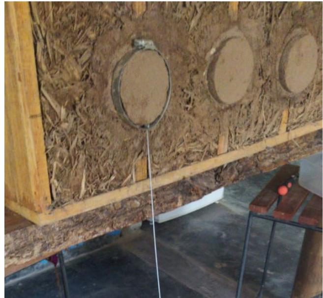
Figura 6. Instrumental de cizallamiento.
