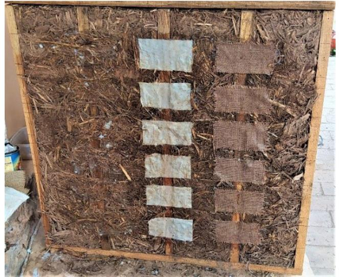
Figura 3. Capas de agarre en paneles para arrancamiento directo.
