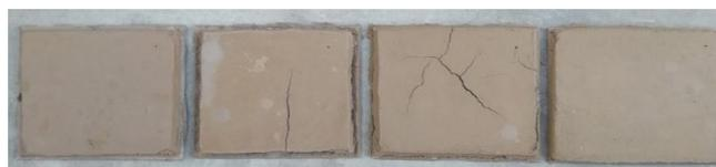
Figura 8. Muestras secas para el ensayo de adherencia por golpe. (De izquierda a derecha las muestras TD, TB, TA1, y TA4).
