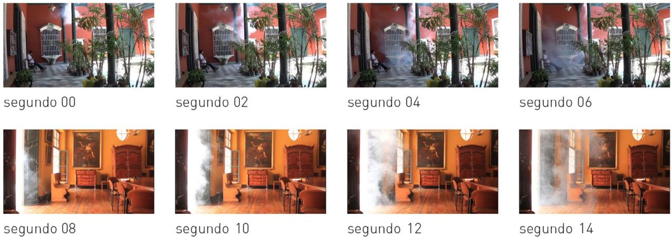
Figura 12: Evidencia del recorrido del aire a partir de la visualización del humo a las 13:20 horas.
