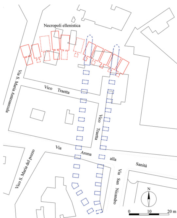
Figura 10. Estudio de tumbas grecorromanas y cimentación de arcadas en el área Vergine-Sanità de Nápoles. Colussi, F. y Leggieri, C. 2016.
