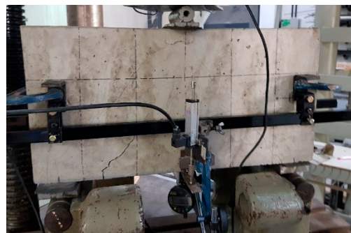
Figura 13. Modo de rotura de VGC de HRFH
