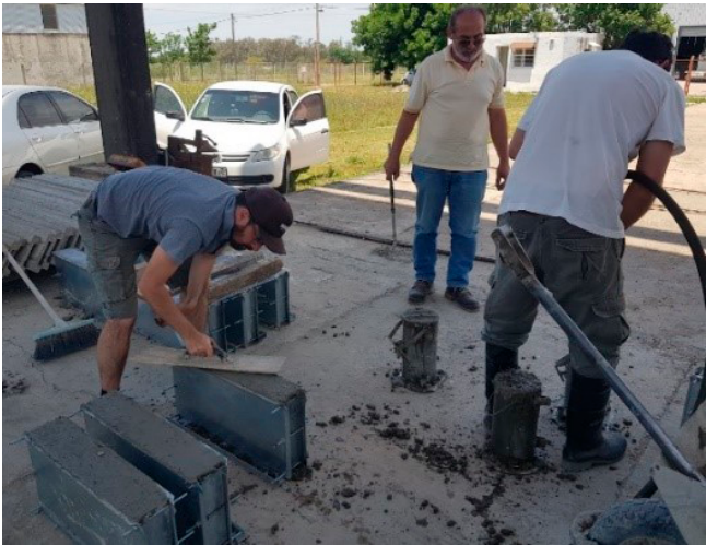
Figura 4. Detalles de llenado y vibrado de los especímenes de VGC
