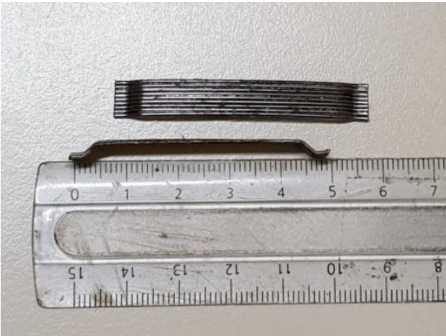
Figura 7 a. Imagen de fibras de acero utilizadas
