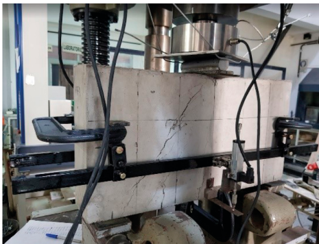
Figura 8 b. Vista lateral de la disposición del instrumental del ensayo a flexión de las VGC
