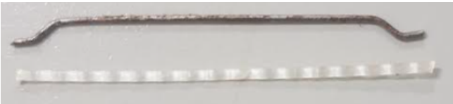
Figura 7 b. Imagen de las macrofibras de polipropileno utilizadas
