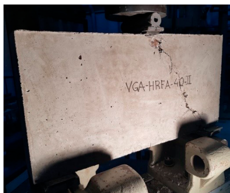
Figura 12. Modo de rotura de VGC de HRFA-05 y armadura de corte reducida
