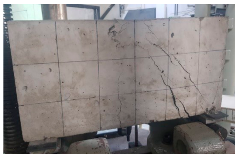
Figura 11. Modo de rotura de VGC de hormigón armado sin fibras y con armadura de corte reducida
