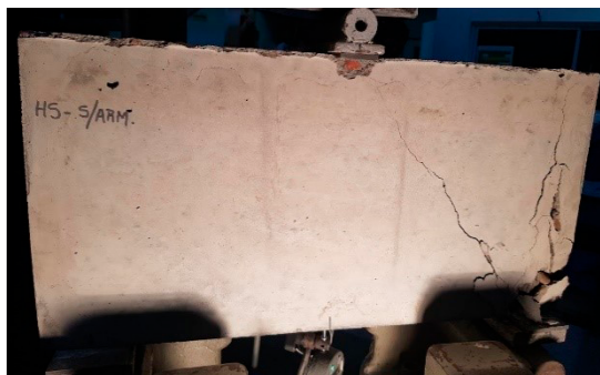
Figura 10. Modo de rotura de VGC de hormigón armado sin fibras y armadura a corte reglamentaria
