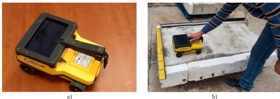
Figura 2. a) Aparato empleado y b) Inspección por georradar de una de las losas del estudio
