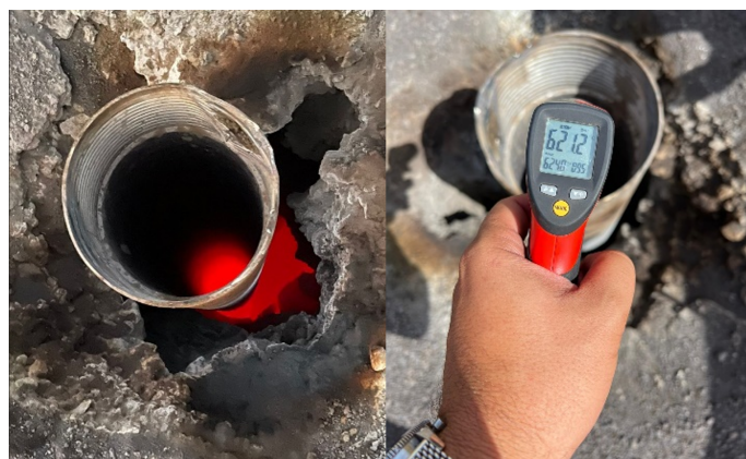
Figura 10. Temperatura de las coladas de lava en el sondeo N° 3 a 3.00 metros de profundidad. Valle de Aridane. La Palma, Islas Canarias. Fuente: Autores
