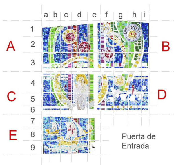
Figura 7. Esquema de la vidriera. División en paños (A, B, C, D y E) en función de su comportamiento estructural
