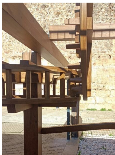
Figura 17. Sistema de engranaje entre ambas ruedas
