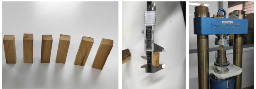
Figura 5. Probetas para ensayos a compresión (izquierda). Calibración de la probeta (centro). Ensayo de compresión paralela a la fibra (derecha). Fuente: Elaboración propia.
