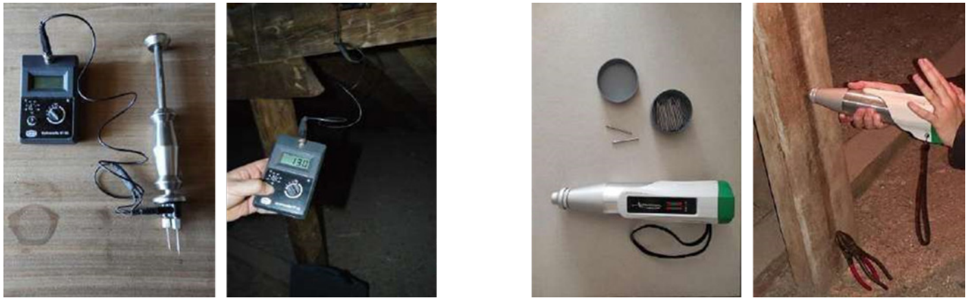
Figura 4. Mediciones con el xilohigrómetro, izquierda. Ensayo con el penetrómetro, derecha. Fuente: Elaboración propia.
