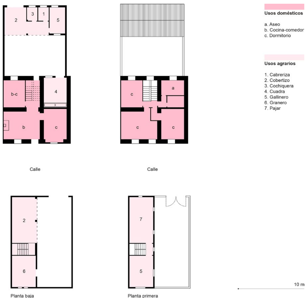
Figura 10b. Parcela de vivienda del pueblo de colonización de Cañatalba Alta con vivienda, dependencias agrícolas y patio de 1958 y las nuevas dependencias agrícolas de 1966 al otro lado de la calle (Elaboración propia en 2024 a partir de los expedientes 14144 y 14812).
