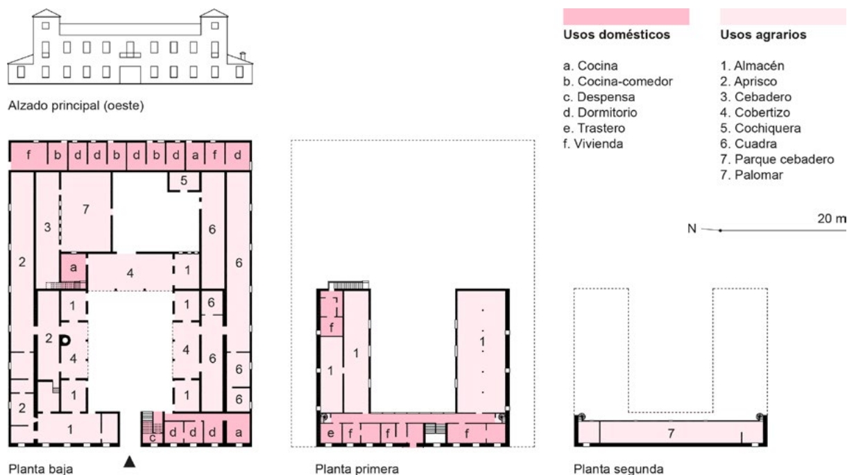
Figura 5. Planimetría de la venta del Chaparral, edificación existente en la finca El Chaparral antes de la intervención del INC sobre ella, demoliendo la venta para la construcción del pueblo de colonización de El Chaparral (Elaboración propia en 2024 a partir del expediente 7889).
