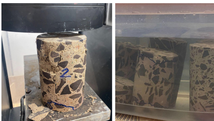
Figura 12. Ensayos realizados en laboratorio sobre testigos cilíndricos
