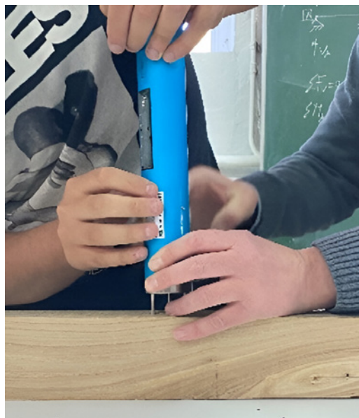
Figura 11. Ensayo de penetración con Pilodyn.
