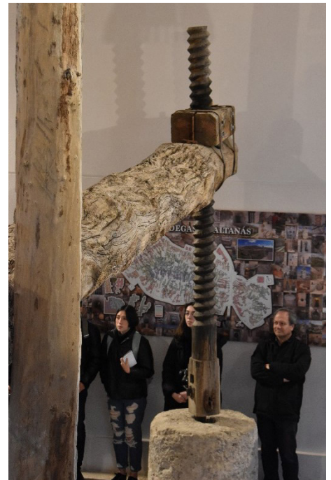
Figura 5. Detalle de la fuerza (prensa del lagar comunal).
